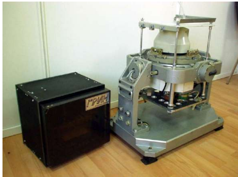
Рис. 1.6. Гравіметричний комплекс “ГРІН-2000”
